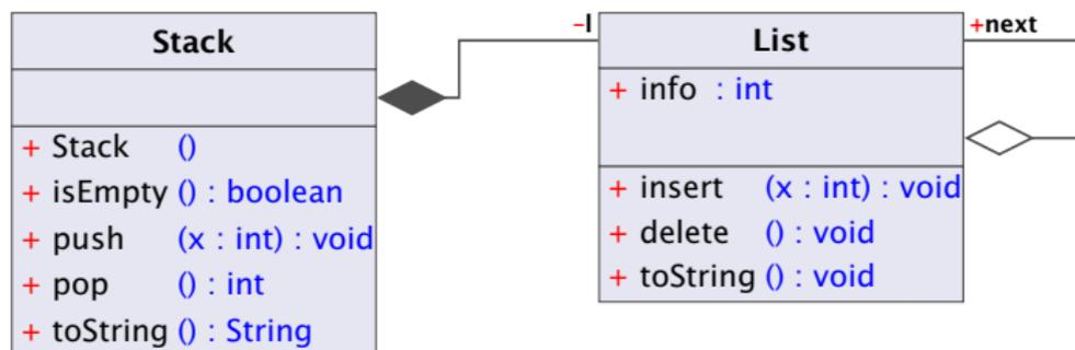
Die **gefüllte Raute** bezeichnet eine **Komposition**. Die Liste existiert nur solange wie der Stack (d.h. wird üblicherweise durch diesen erzeugt und zerstört). Außerdem kann die Liste nur Teil eines Stacks sein.
